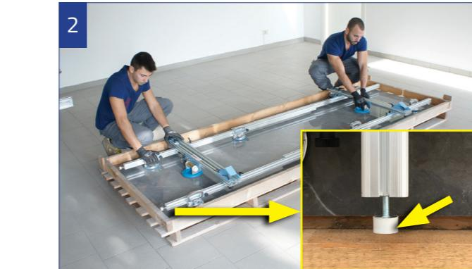
Adattare il telaio alla lastra e distribuire le ventose in maniera omogenea, mettere in depressione le ventose, posizionando i piedi in gomma fuori dalla lastra.
