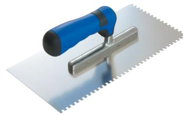
Per la spalmatura dell'adesivo sul retro della lastra si consiglia l'utilizzo di una spatola a denti quadri 4x4 mm.
