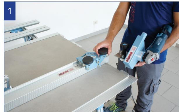
Posizionare la guida KERA-CUT sulla lastra, togliere il carrello incisore e sostituirlo con il KERA-FLEX.
